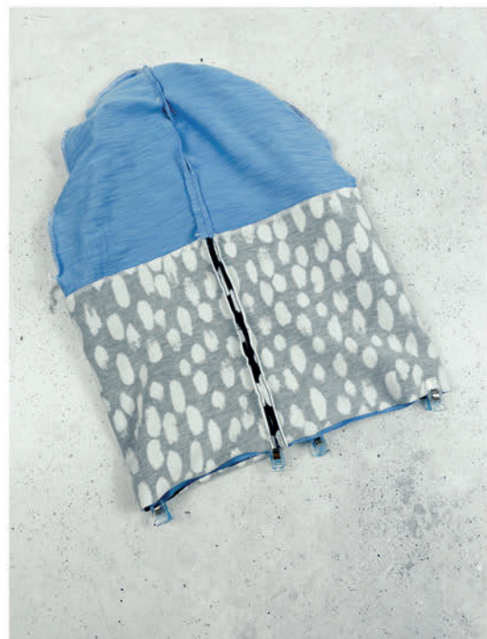
16. Stecke die untere Kante fest und schließe sie mit der Overlock.
